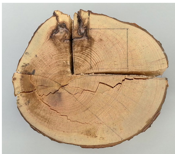
Fot. 1. Badany krążek z wyciętym fragmentem, przeznaczonym do badań wybranych właściwości fizycznych drewna, wraz z zaznaczonymi ołówkiem liniami cięcia próbki do dalszych badań (fot. R. Wąsik)
