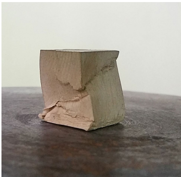
Fot. 7. Zniszczona próbka drewna po teście wytrzymałościowym na ściskanie z widocznym skrzyżowaniem włókien (fot. R. Wąsik)
