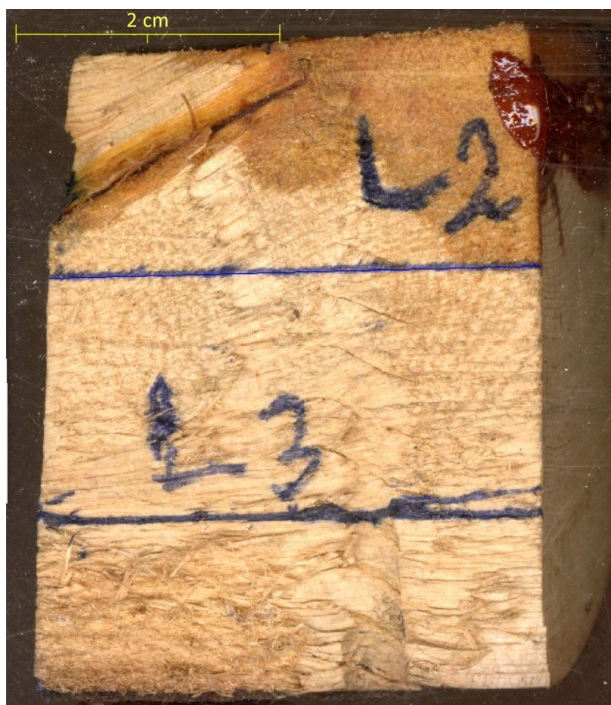
Fot. 4. Przekrój podłużny fragmentu badanego krążka, z widocznym skrzyżowaniem włókien (fot. R. Wąsik)
