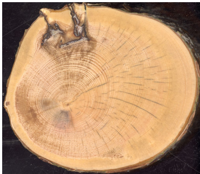
Fot. 3. Przekrój poprzeczny badanego krążka z widocznymi wadami drewna (fot. R. Wąsik)
