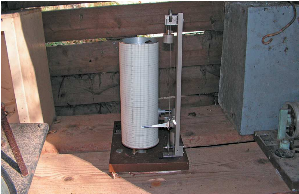
Fot. 2. Limnigraf przy zaporce pomiarowej na potoku Biała Woda, fot. A. Jaguś
