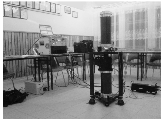
Fot. 1. Grawimetr absolutny FG5 na punkcie pomiarowym w Niedzicy. FG5 absolute gravimeter at Niedzica station.
